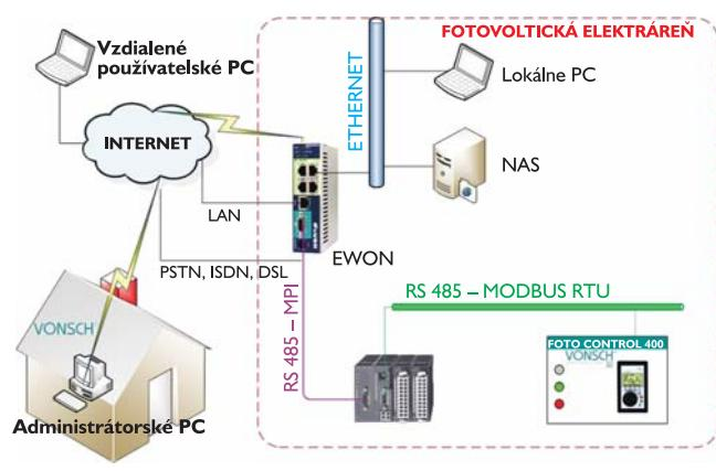
Konfigurácia jednoduchej centralizovanej elektrárne s výkonom 60 kW
