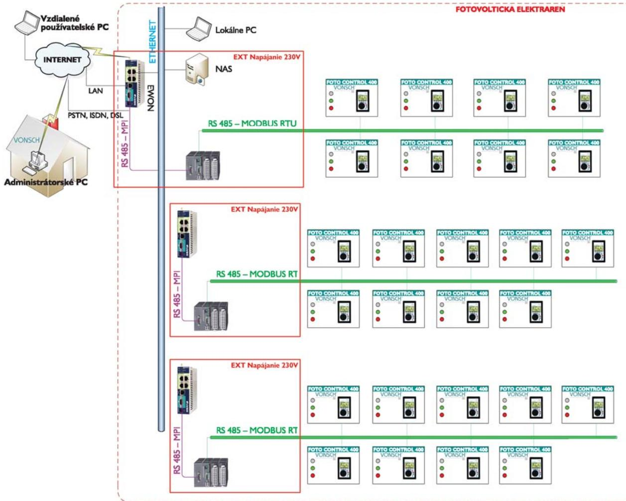
**Konfigurácia decentralizovanej elektrárne s výkonom 1 MW má niekoľko komunikačných uzlov.
